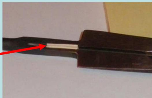
Fissare il cuneo con del nastro arrotolandolo sul codolo
