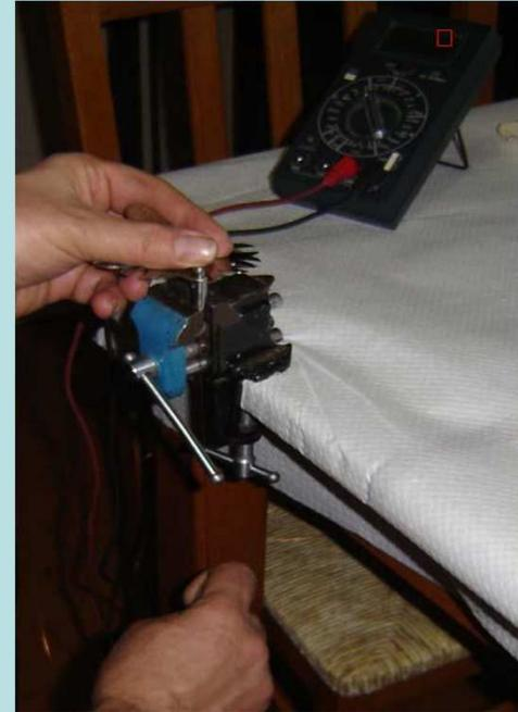
Effettuare il controllo della chiusura del contatto inserendo come da figura la lamina dello spessore da 0.5 mm
