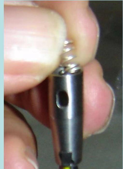
Da tenere presente che se la chiusura del contatto avviene con una lamina inferiore a 0,3 mm è regolamentare ma è svantaggioso per l'atleta.
